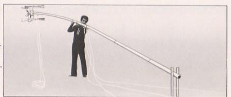
必ず杭の上の穴でポールと接合してポールを起します。
